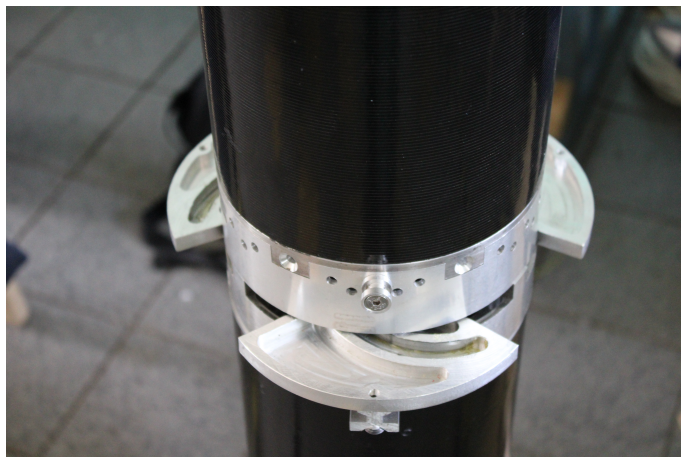
Figure 10: Système d'aérofreins ouvert
