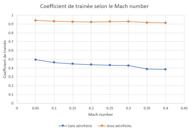
Figure 12: Résultats numériques du Coefficient de trainée par CFD
