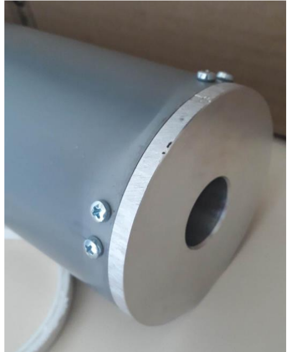
Fig 5. Pièce inférieure du logement-moteur visée au tube de la fusée
