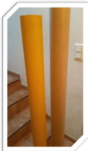
Tubes de carton pour le fuselage de APOGÉE (à droite) et \Delta SHIP (à gauche)
