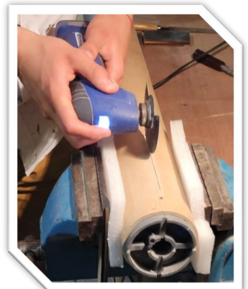
Cette tâche fut répétée sur le tube de ΔSHIP afin d'intégrer les quatre ailerons
