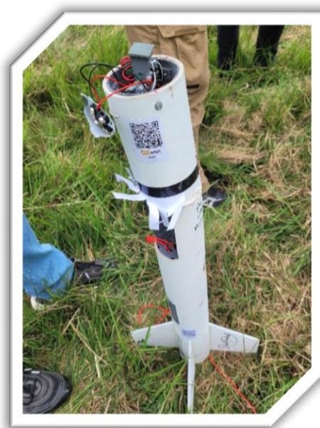
A gauche, nous pouvons voir la violence du choc sur la trappe qui, avec la coiffe et une partie du tube, sont les seuls éléments endommagés. La rigidité du carton a permis d'encaisser une partie du choc et donc de limiter les dégâts.
