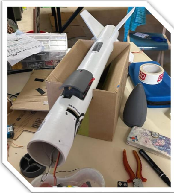
Etape clé avant la qualification et le vol : l'intégration (assemblage) globale de TOUS les composants de la fusée (À GAUCHE-APOGÉE ; À DROITE- \Delta SHIP)
