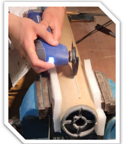
Exemple de découpage à la scie oscillante sur le « TAT » d'interstices pour l'intégration des ailerons
