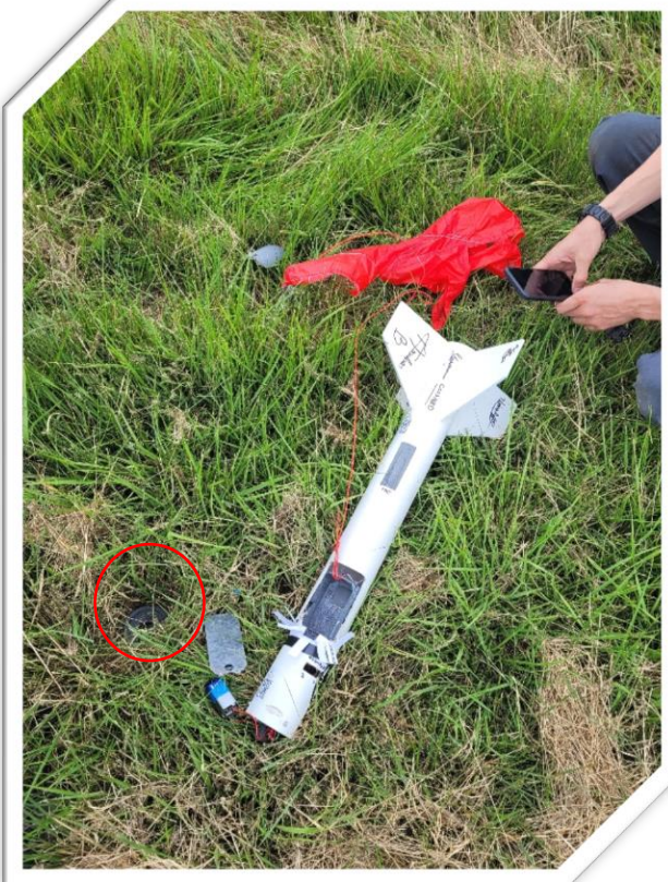
Apogée lors de la récupération (la coiffe s'est entièrement plantée dans le sol lors de l'impact)
