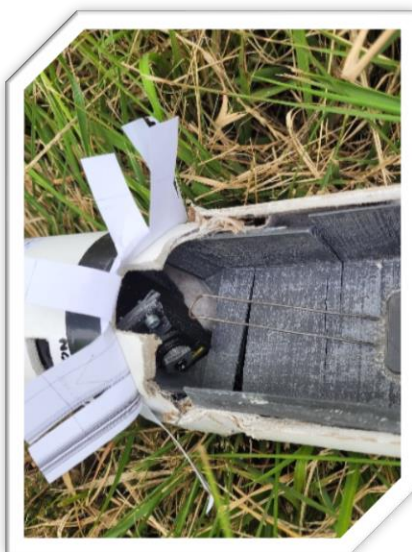
A gauche, nous pouvons voir la violence du choc sur la trappe qui, avec la coiffe et une partie du tube, sont les seuls éléments endommagés. La rigidité du carton a permis d'encaisser une partie du choc et donc de limiter les dégâts.
