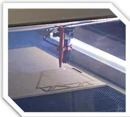
Découpage laser d'ailerons en contreplaqué bois
