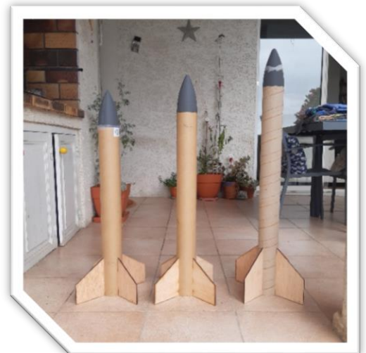
Fusées avec ailerons en contreplaqué, fuselage en carton et coiffe en PLA assemblées : FUSÉE DE TEST* (à gauche) APOGÉE (au milieu) et \Delta SHIP (à droite)
