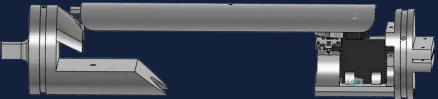
A droite se situe le servomoteur dédié à l'ouverture de la trappe dont nous parlerons plus tard, en haut se situe la trappe, et à gauche se situe une pièce de type « toboggan », facilitant l'éjection du parachute en dehors de la trappe. Sa forme étrange s'explique par le passage de fils électroniques (rigole en dessous de la pièce), par le lien à un PCB fixe à gauche, et par la présence initiale d'un ressort en son centre, exerçant une force de pression sur la trappe.
