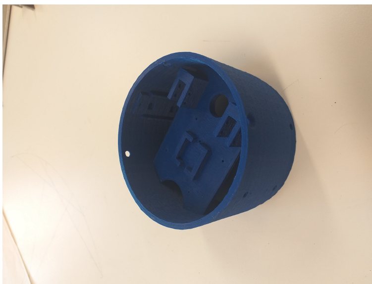
FIGURE 17 – Allongement de la fusée imprimé en plastique ABS
