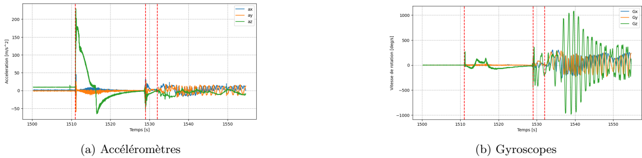
FIGURE 47 – Accélération et vitesses de rotations dans le référentiel de la fusée. L'axe Z est l'axe de la fusée.
