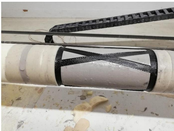
Figure 3 - Renforcement du tube au niveau des aérofreins
