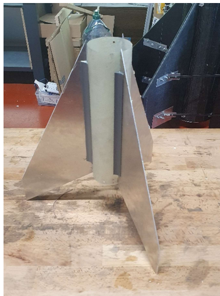
Fixation des ailerons sur le corps de la fusée
