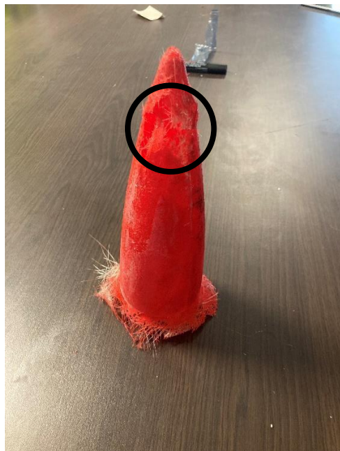
Coiffe en fibre de verre avec la zone trouée à remplacer
