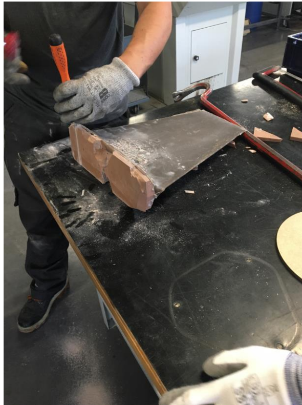
Figure : extraction difficile de l'aileron en fibres de lin
