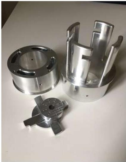
((a)) Bagues du système, avant assemblage
