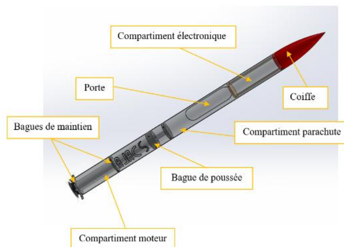
Figure n°2 : Modèle SW de la fusée
