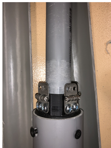
Figure 8: Charnières de fixation des pales
