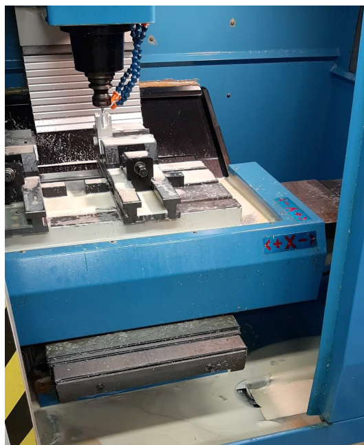
Figure 6: Usinage d'une fixation d'aileron
