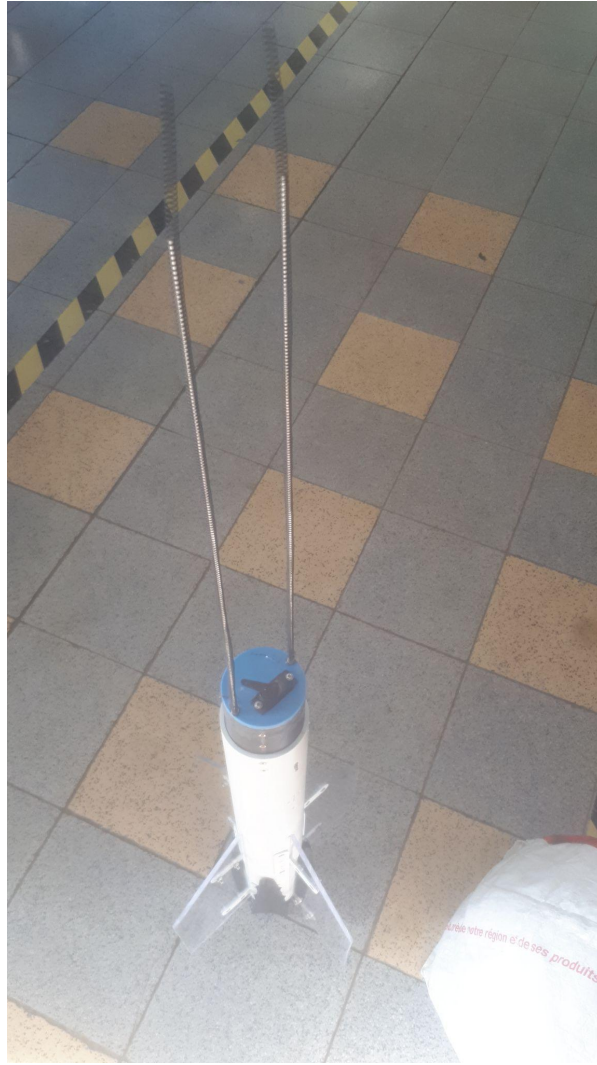
Ressorts de compression et tiges plus longs fixés sur le centrage long
