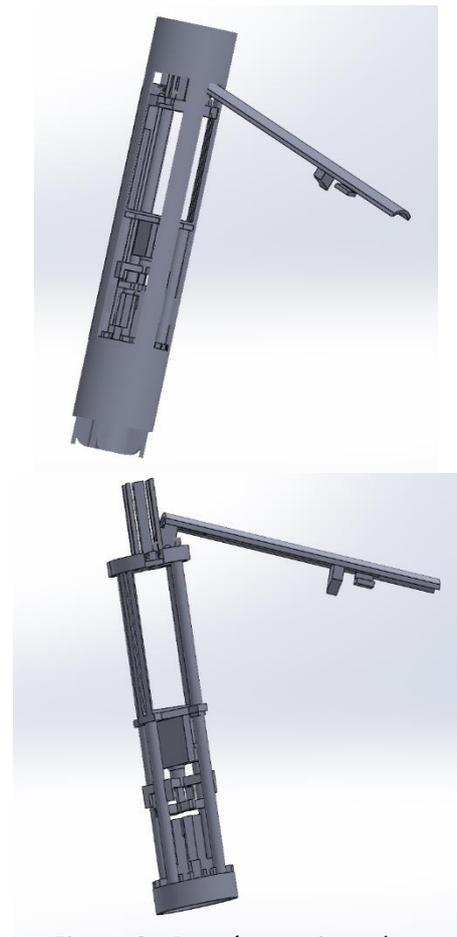
Figure 9 : Représentations du compartiment intermédiaire avec et le corps porteur.
