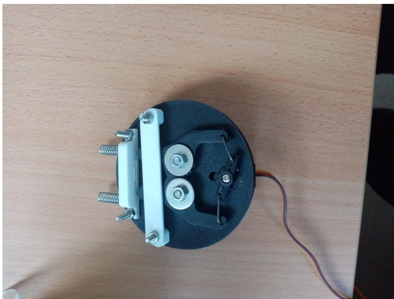
Figure 5: vue du système d'éjection de la trappe avec les deux ressorts. La languette est absente sur la photo
