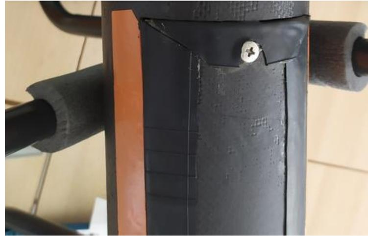
**Figure 6.2** : Ajout d'une chambre à air autour de la trappe
