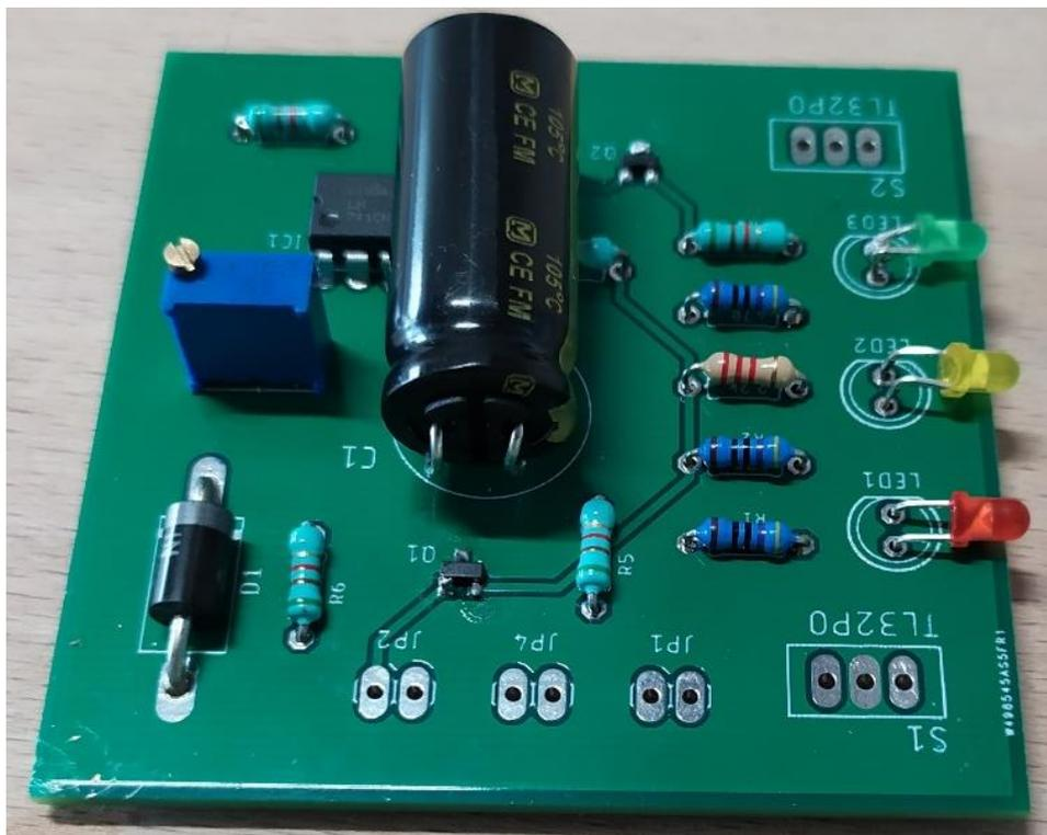
Figure 4.3 : Minuterie avec composants assemblés sans connecteurs ni interrupteurs
