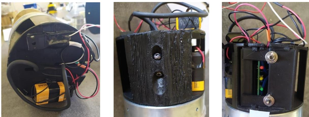
Figure 4.7 : Minuterie assemblée dans son rack et circuit de puissance
