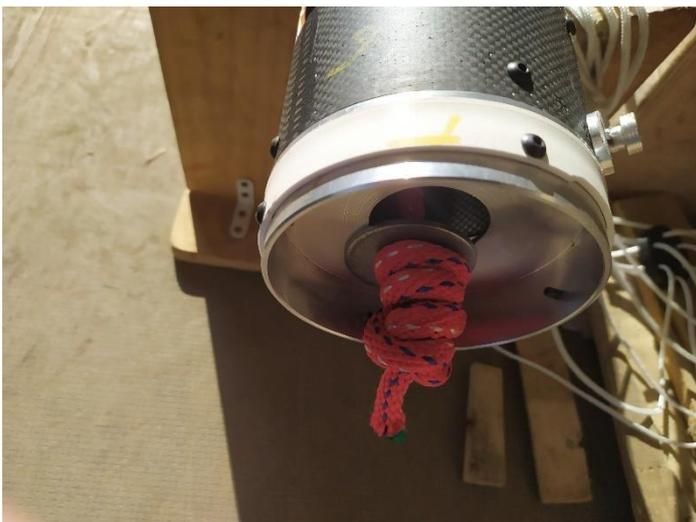
Le nœud de capucin permet d'attacher la suspente principale (corde rouge), et par extension le parachute à la bague faisant l'interface entre la récupération et la coiffe. La suspente principale est attachée à l'émerillon grâce à un nœud de 8 (non indiqué sur les photos).
