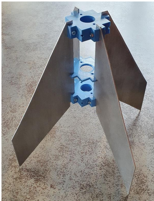
Module des ailerons sans la bague de reprise de poussée
