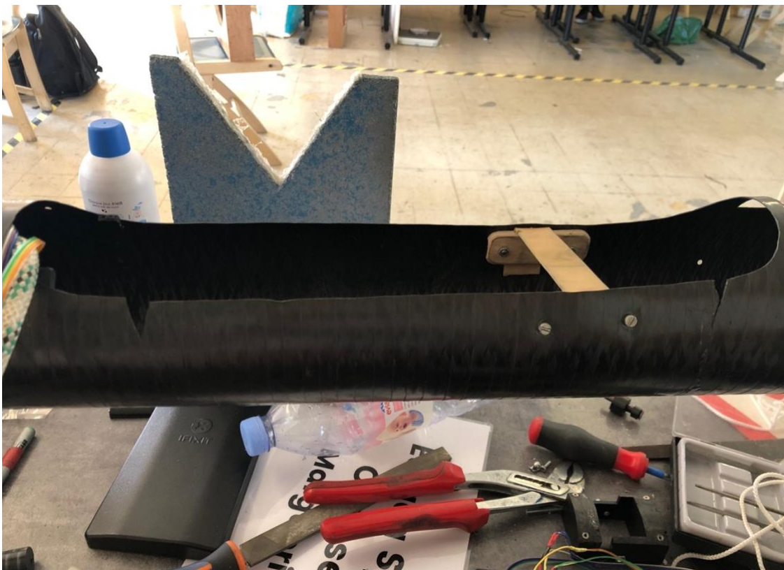
Figure 6 : Peau fissurée suite au vol
