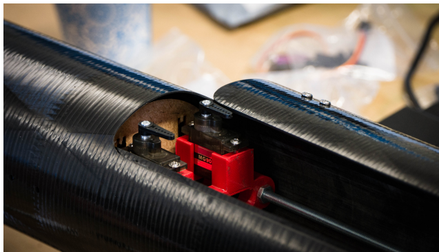
Figure 10: Système d'ouverture de la porte du parachute.
