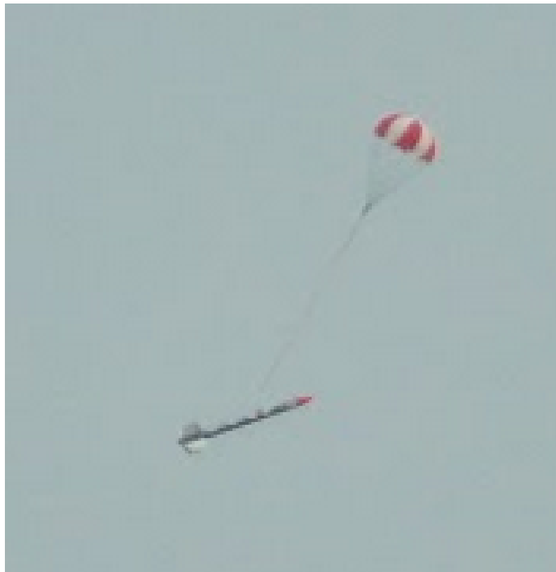
FIGURE 13 – Fusée sous parachute, on remarque l'absence de la porte qui devait être située au niveau de la cheminée du parachute
