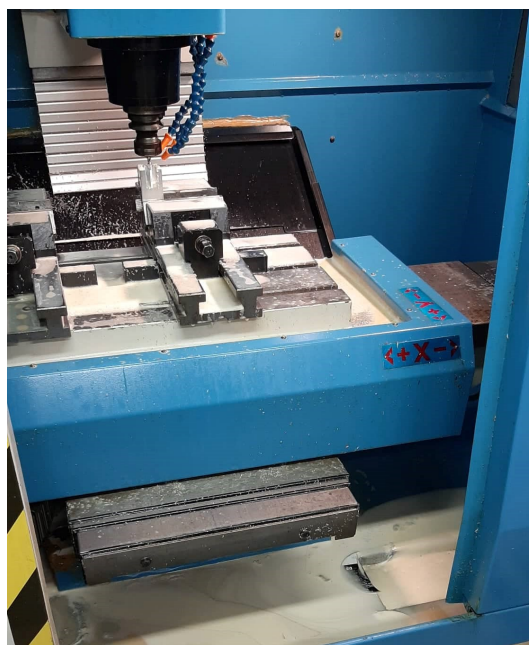
Figure 6: Fixation à aileron en train d'être usinée
