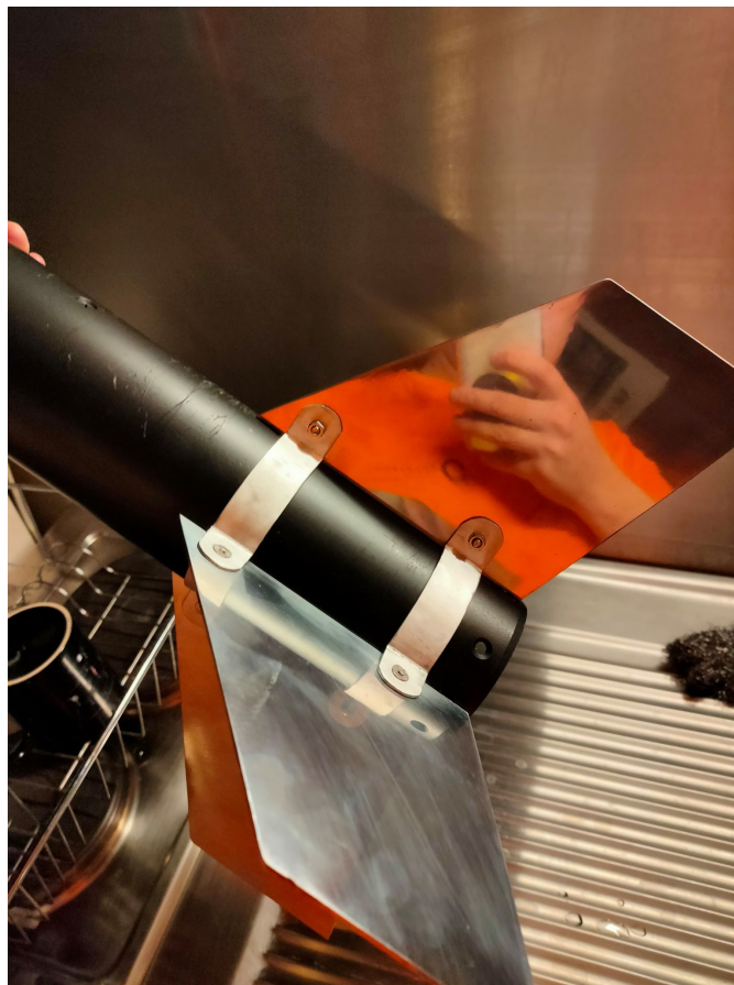
FIGURE 3.5 – Fixation des ailerons sur le corps.
