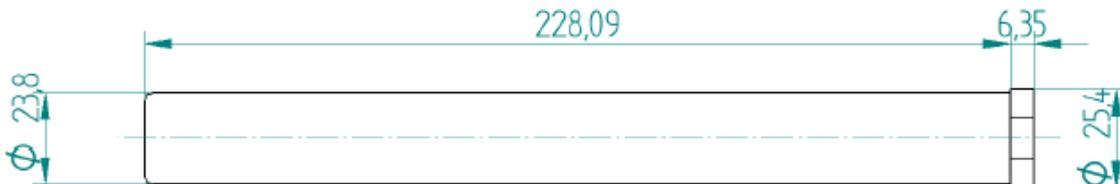
Figure 2: schéma et dimensions du propulseur Pandora (dimensions en millimètre)
