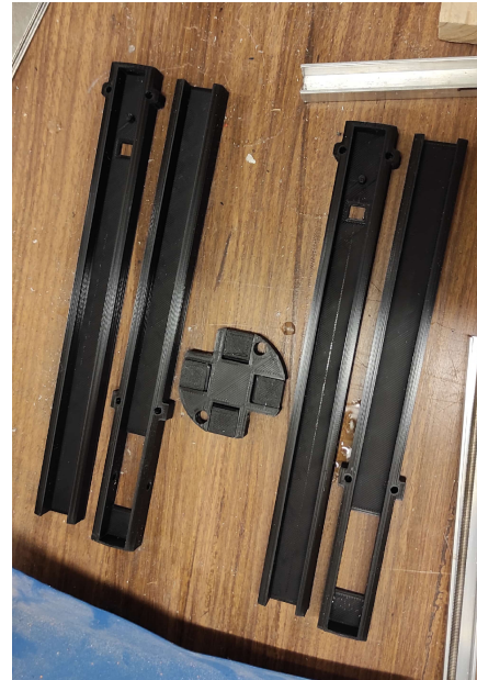
Figure 9 – Logement pieds + bague bascule
