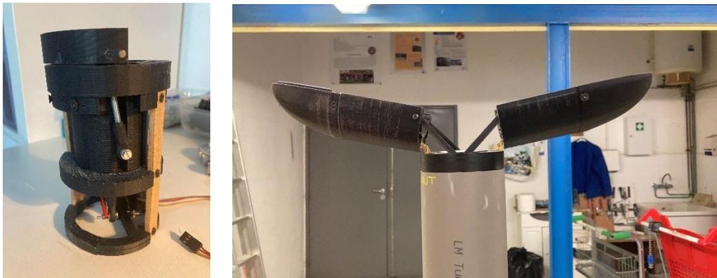
Figure 7 – Système final retenu pour l'éjection du parachute par la coiffe
