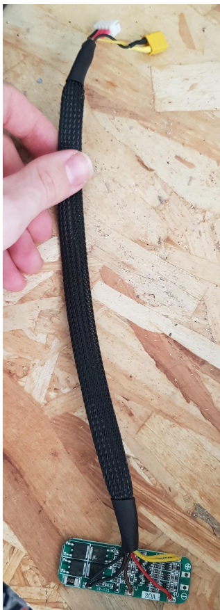
Photo d'un BMS et des fils gainés reliés aux connecteurs
