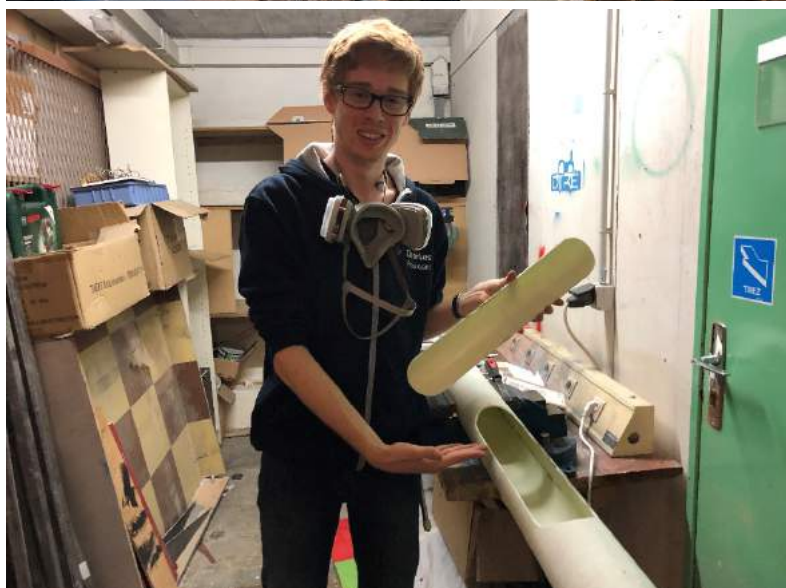
Figure 7 : Photos de la découpe de la trappe à parachute
