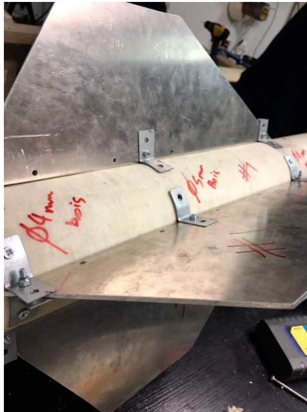
Figure 4 : fixation des ailerons
