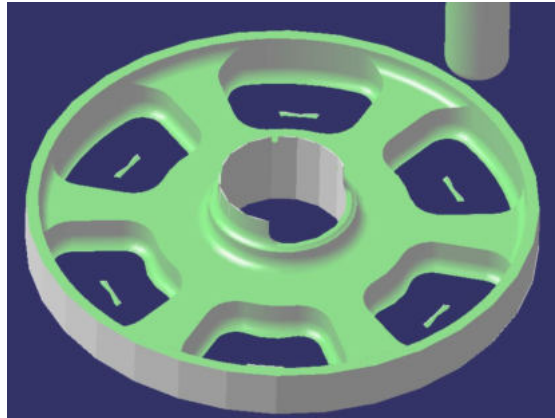
Figure 6: Fabrication Assisté par Ordinateur de la bague d'ancrage du parachute
