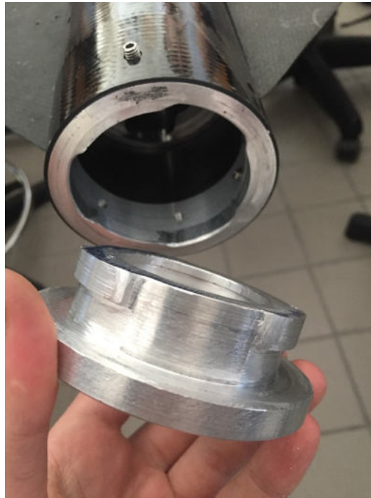
Figure 23: système initial de fixation du propulseur
