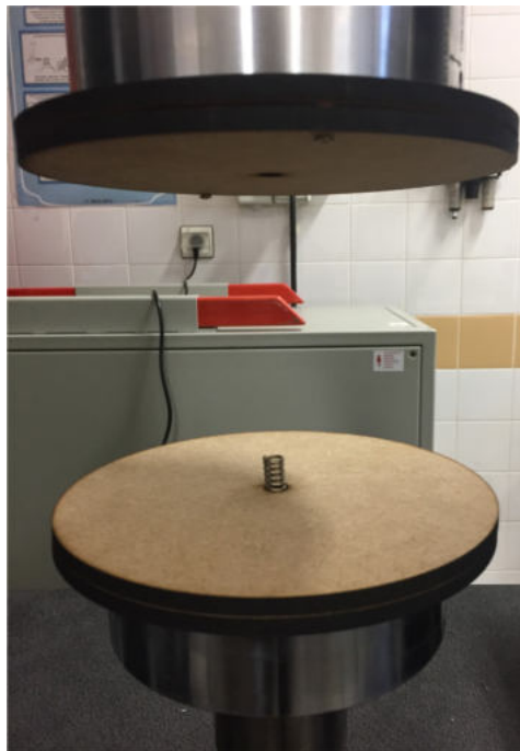
Figure 38: test de compression sur les 2 ressorts
