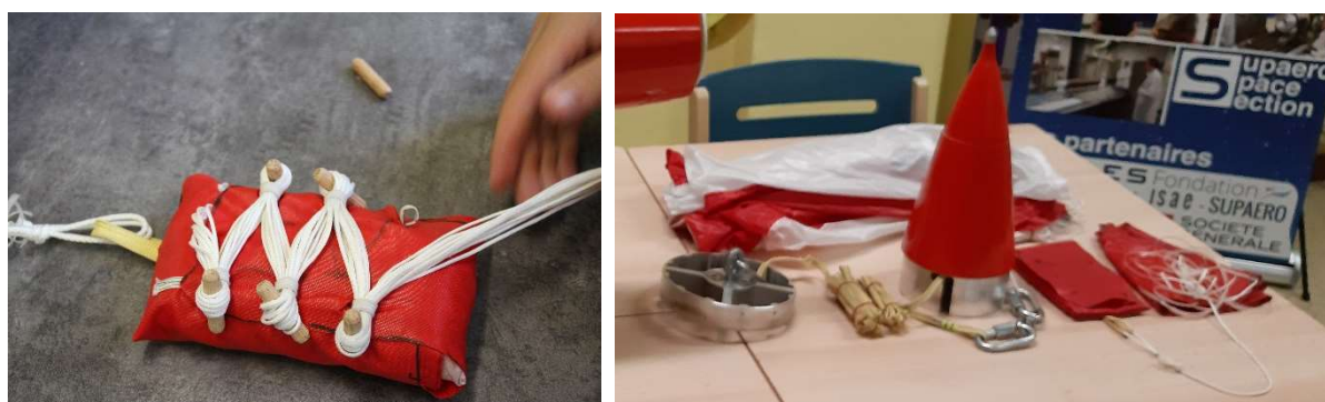
Fig. 9 Tressage des suspentes autour du sac à parachute (à gauche) les tourillons présents ne servent qu'au maintien, ils sont retirés en vol, et contenu de la partie haute du nez (à droite)
