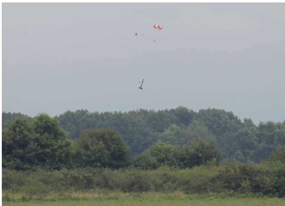
Fig. 14 Retombée de SCALAR IV-B sous son parachute. On remarque que la fusée est anormalement basse par rapport à son parachute, ce qui pourrait s'expliquer par la rupture de la boucle d'attache principale. Par ailleurs, on ne voit pas le nez qui devrait pendre au-dessus du corps de la fusée, renforçant cette théorie.
