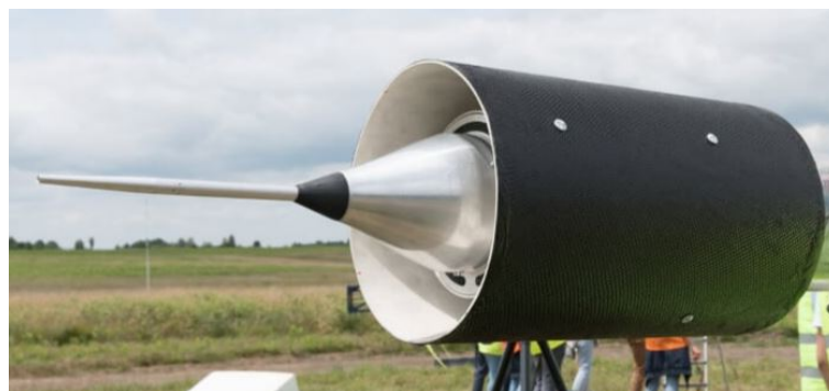
FIGURE 4.1 – Vue du statoréacteur inerte et du tube de pitot
