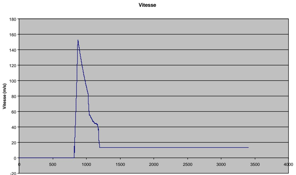
On voit bien les trois phases de vol. Accélération de 0 à 150m/s. Puis une vitesse autour de 15m/s pendant la descente sous parachute.
