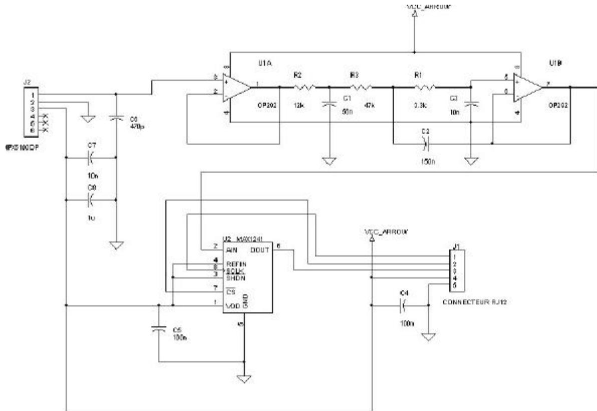
Au niveau process, c'est le même que pour les autres capteurs, on a du 12V qui est régulé en 5V, puis un système d'AOP et de CAN.
