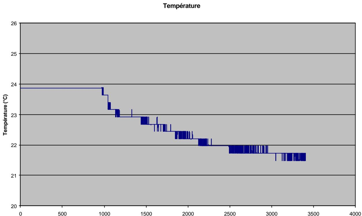
Comme on le voit sur la courbe, la température a très peu variée durant le vol. Nous avons noté une température de 23.9°C au sol et de 21.5°C en l'air. On voit nettement que le capteur a mal été calibré et laisse apparaitre de ce fait des limites de résolution.
