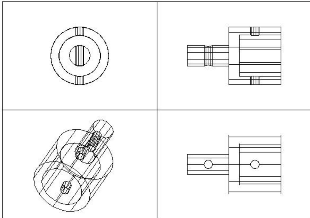
Plan mécanique 3: Adaptateur du tube de Pitot
