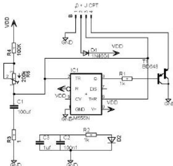
La minuterie est faite à partir d'un montage mono stable de NE555, quand le Jack est enlevé, le circuit RC (à gauche) se charge, et au bout d'un moment, la tension de seuil haute du trigger est atteinte et donc la sortie Q passe à 0. Le transistor qui est un NPN est passant et le servomoteur peut tourner. Nous avons aussi une led bleue qui indique aussi que la carte est allumée.
