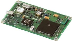
On utilise un récepteur Motorola Oncore VP, à 8 canaux parallèles, qui s'interface simplement avec une liaison série, au format RS232 et aux niveaux TTL. Ce modèle est disponible à petit prix comme fin de stock.
