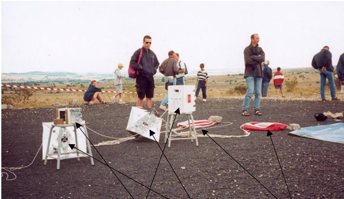
*Chaîne de vol : avec les deux nacelles, deux réflecteurs radar et deux parachutes*
