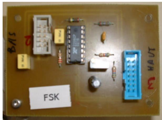
sont  $f_1$  (9kHz) et  $f_2$  (15kHz) et sont donnés par la relation :  $f_1 = \frac{1}{R_1.C}$  et  $f_2 = \frac{1}{R_2.C}$ .
