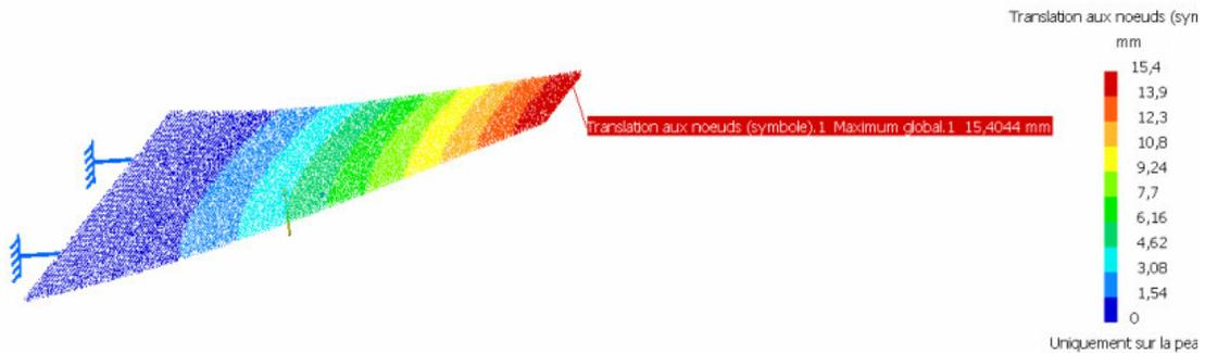
Figure 17 : Déformation de l'aileron soumis à une force transversale
