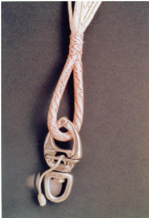
L'ensemble de la chaîne de récupération a été sur-dimensionné afin de garantir une descente sous parachute en cas d'ouverture prématurée ou extrêmement tardive. Dans ce cas, on peut atteindre des efforts allant jusqu'à plusieurs tonnes.
