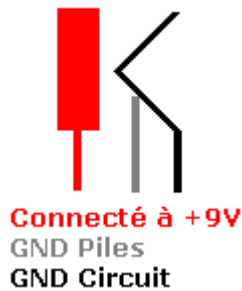
Figure 2 : Prise Jack nue, alimentation par les piles.
