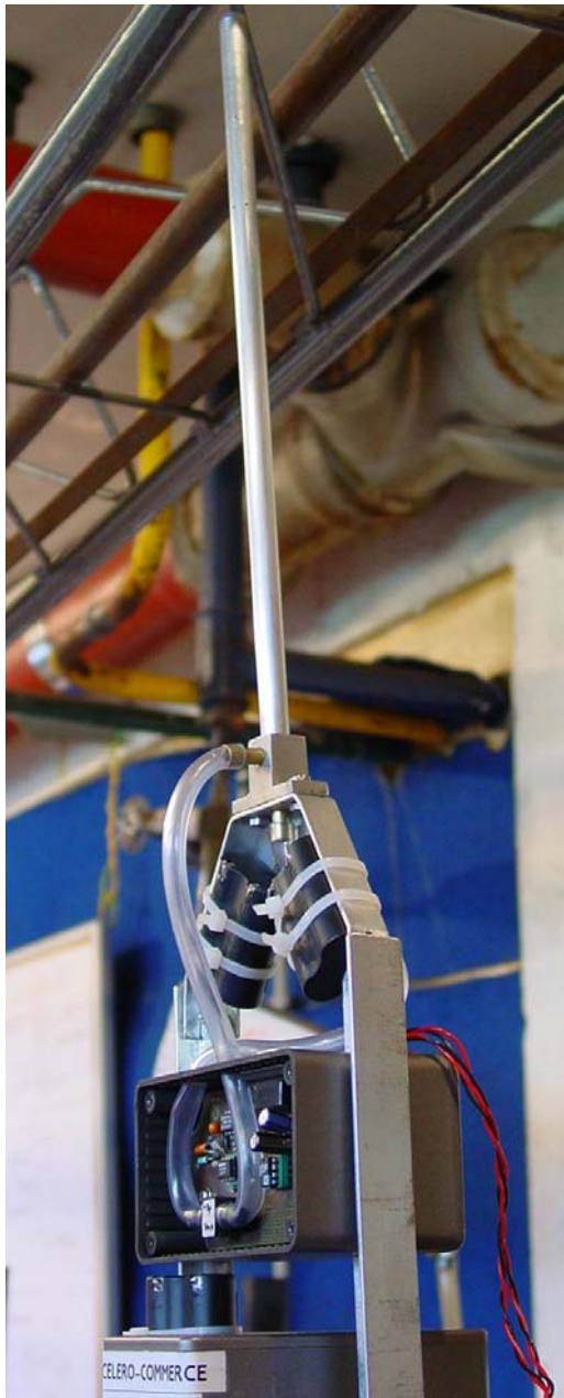
Figure 5 : Vue du tube de Pitot et de la carte.
