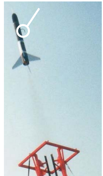
Figure 21 : Décollage aXelle - déformation de l'antenne de transmission
