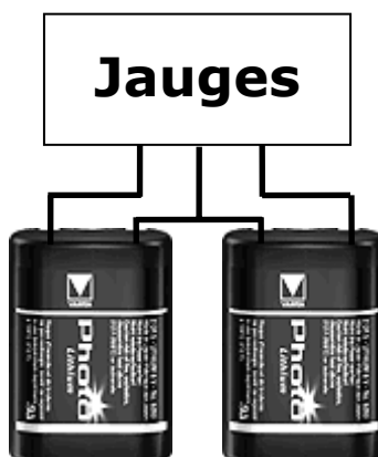
Figure 15 : câblage des piles de l'expérience accéléro jauges
