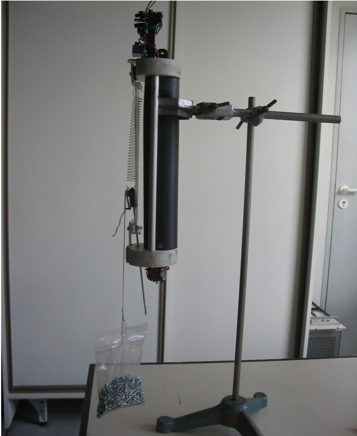
Sur cette photo, on distingue le tambour tournant (de couleur noire) le circuit électronique dans la partie supérieure, le moteur d'entraînement (partie inférieure) et les deux bagues de fixation de l'ensemble sur le corps de la fusée.
