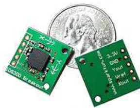
Figure 18 : Platine de Déploiement Gyroscope à Deux Axes \pm 500^\circ/\text{sec}
