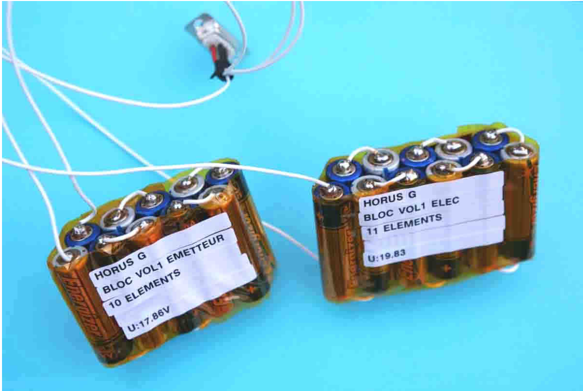
On voit ici les 2 blocs de vol réalisés conformément aux calculs ci-après. (Photo G07Y052 Photo GAREF PARIS)
