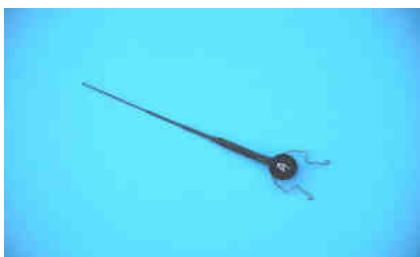
Une des 2 balises (total 8g avec pile, par balise) (G07Y053 GAREF PARIS)
