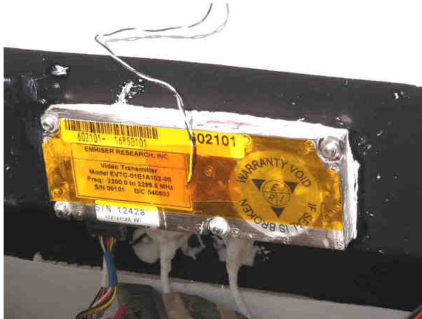
Emetteur de télémétrie 2 GHz (Photo G07Y051. Photo GAREF PARIS)
