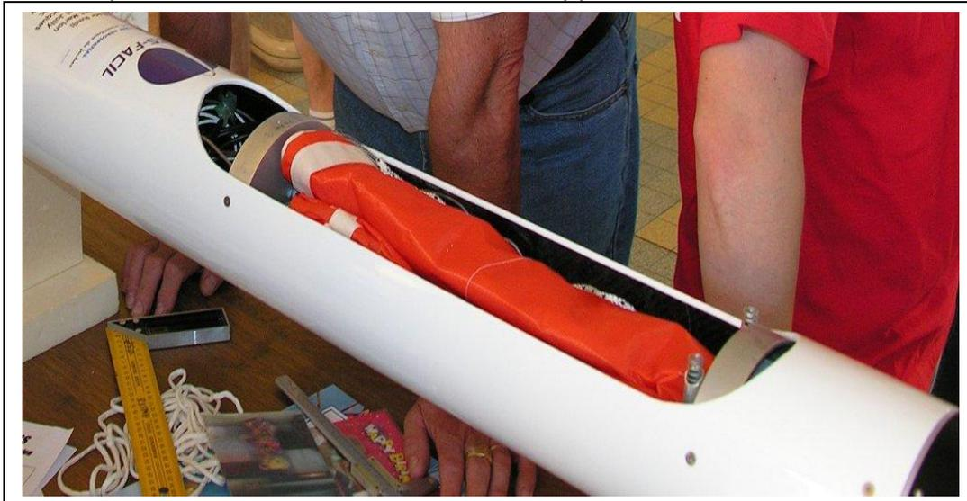
A l'image de l'architecture FH-01, la porte de la case parachute est directement découpée dans le tube porteur en carbone. Le volume de la case parachute est délimité par 2 bagues en aluminium qui encadrent la case des 2 cotés. La bague supérieure comporte le système de déverrouillage et d'éjection de la porte. Elle est libérée par un verrou commandé par un servomoteur ou un moteur à courant continu. L'éjection est assurée par 2 ressorts de compression situés de part et d'autre du verrou.
