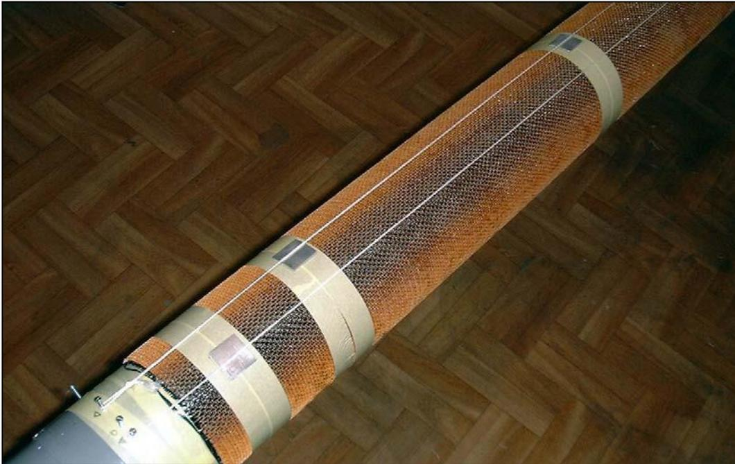
Repérage des positions des inserts avant la pose de la 2ème couche de carbone.
