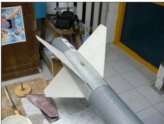
Positionnement des ailerons (collage à l'araldite) sur le tube de base Deux axes d'orientation
