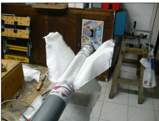
Stratification des tissus de renfort entre chaque paire d'ailerons
