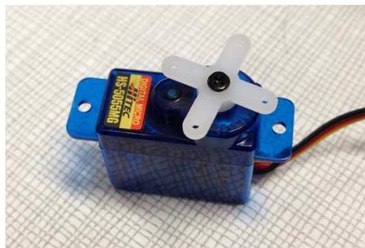
Figure 21 : Photographie du servomoteur HITEC HS-5055MG
