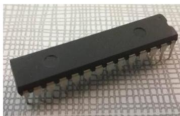
Figure 31 : Photographie du microcontrôleur PIC 18F2685
