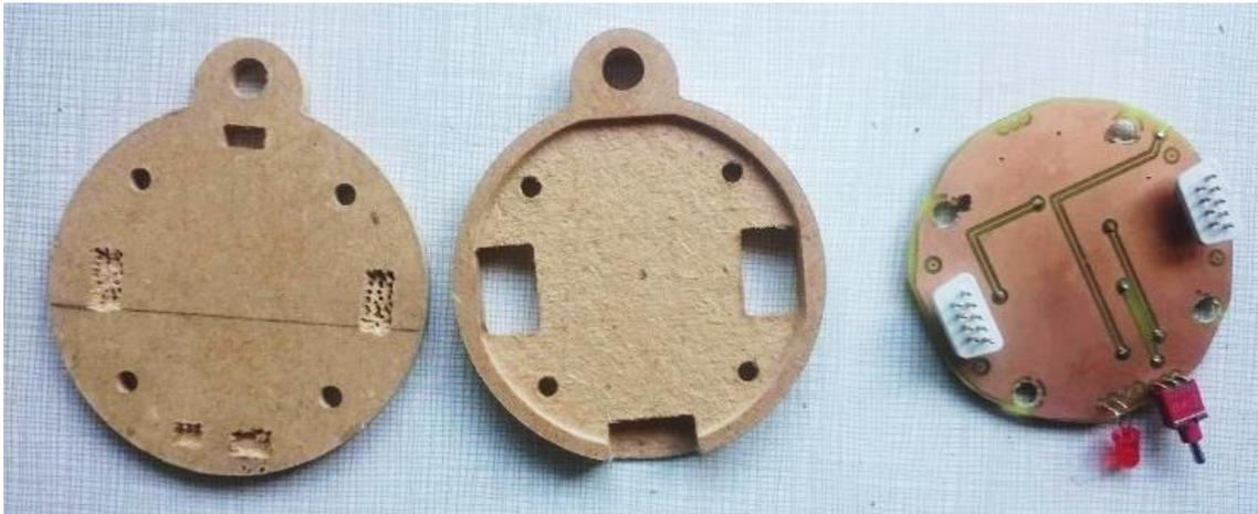
Figure 10 : Photographie de la bague mixte et de sa carte électronique
