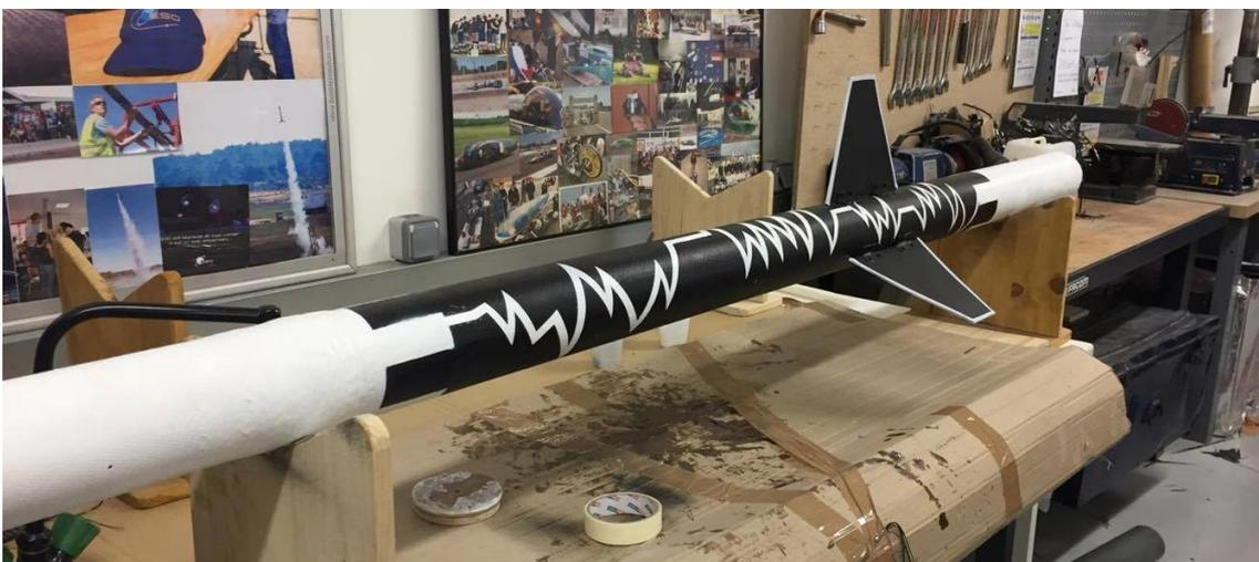
*Réservoir de la fusée avec ailerons assemblée et peau de l'étage avionique (en blanc)*
