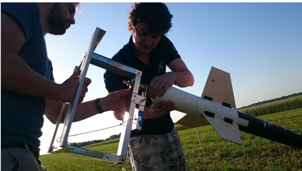
*Fixation de la rampe à la fusée pendant le vol pour Matriochka*
