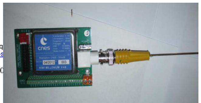
L'utilisation du système Kiwi Millenium est à comparer avec celle d'un simple voltmètre dont les pointes de touche seraient dans la nacelle et l'afficheur au sol. Il mesure des tensions et transmet ces valeurs au sol. Il est nécessaire d'étalonner pour connaître la correspondance tension / paramètre physique mesuré. L'émetteur Kiwi Millenium permet d'envoyer 8 mesures simultanément toutes les 2 secondes. La distance de transmission est supérieure à 200 km<sup>4</sup>.
