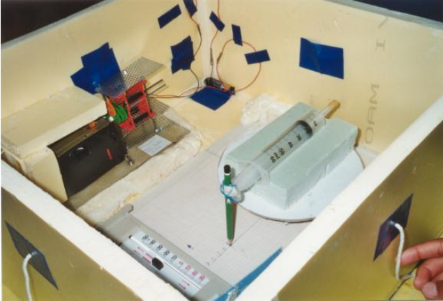
Mesure de pression par seringue
