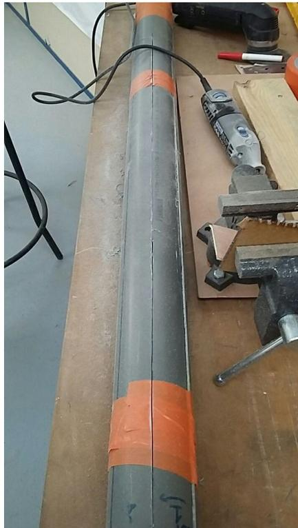
FIGURE 25 – Méthode de découpe de six pales dans un tube
