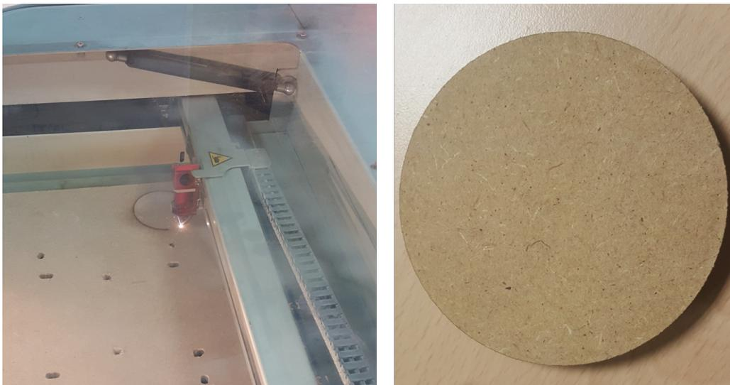
FIGURE 28 – Découpe de la bague propulseur
