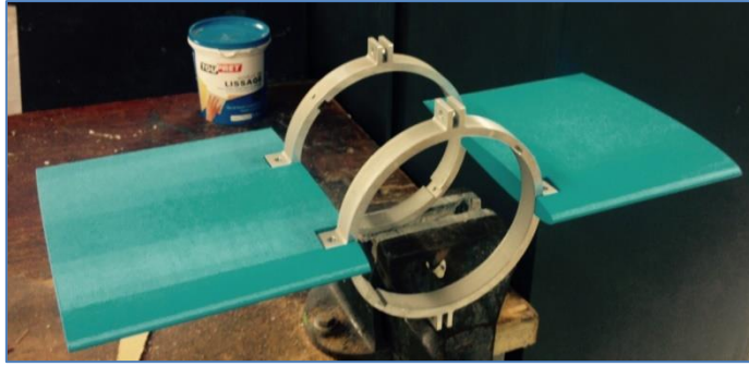
Figure 25 Ailerons profilés imprimés 3D et leurs bagues de fixation
