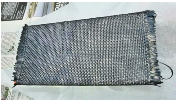
Figure 24 1er test de drapage de fibre de carbone autour d'un profilé en plastique
